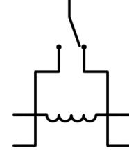
Le relais est un interrupteur électromécanique, ce qui signifie qu'il change de position ou d'état grâce à un électroaimant. Il peut donc être commandé par un signal électrique dans un circuit. Le relais est utilisé pour relayer une commande sur un circuit de plus forte puissance. Comme l'électroaimant contient une bobine, il est nécessaire d'utiliser une « diode de roue libre ».
