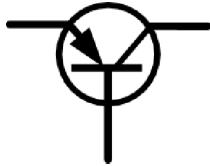
Le transistor est une association de trois couches de semi-conducteurs et dont la couche du milieu sert à contrôler le passage du courant dans les deux autres. Il s'agit d'un composant actif qui est souvent utilisé comme **amplificateur ou interrupteur**, à la manière d'un relais.
