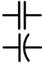
Le condensateur (« capacitor » en anglais) est constitué de plaques de conducteurs, éléments qui permettent l'échange d'électricité, séparées par un isolant. Un condensateur est capable d'emmagasinier une tension électrique, un peu à la manière d'un réservoir: Sa valeur caractéristique est la capacité, notée C et exprimée en Farad (F).
