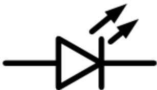
La LED est une diode électroluminescente : elle s'allume lorsqu'un courant passe dedans. Sa cathode (-) est plus courte que son anode (+). C'est un composant pratique pour visualiser rapidement les états de certains circuits, car elle est facile à mettre en œuvre et consomme peu de courant (en général 6 à 20 mA). Une LED se caractérise par sa tension de seuil qui exprime la tension à ses bornes lorsqu'elle est alimentée.
