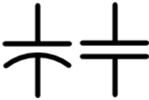
Le condensateur (« capacitor » en anglais) est constitué de plaques de conducteurs, éléments qui permettent l'échange d'électricité, séparées par un isolant. Un condensateur est capable d'emmagasiner une tension électrique, un peu à la manière d'un réservoir. Sa valeur caractéristique est la capacité, notée C et exprimée en Farad (F).
