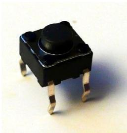
2 interrupteurs pour circuit imprimé
